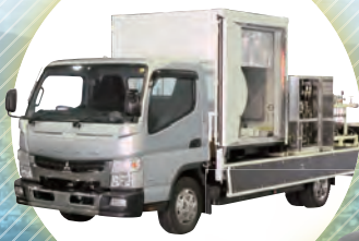
残留ガス回収装置
